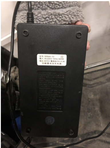
无PFC功能劣质大功率充电器
